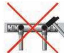
Фасонные части нельзя выправлять молотком
